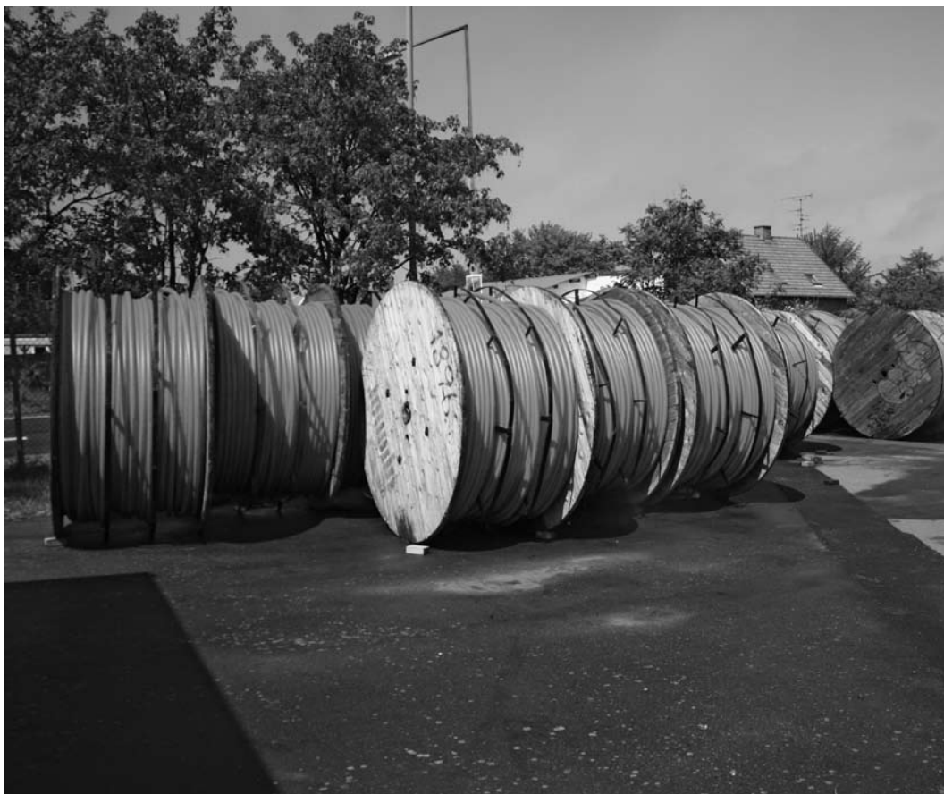
Tomrør til fiber, opmagasineret ved Østkrafts Linielager.
